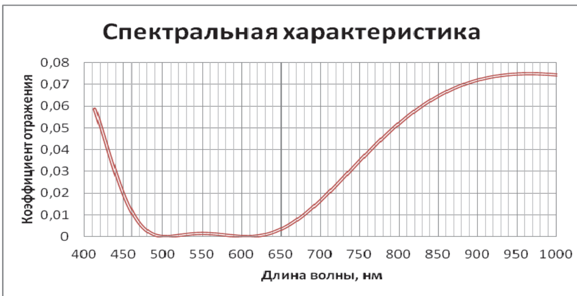
Спектральная характеристика многослойного просветляющего покрытия
