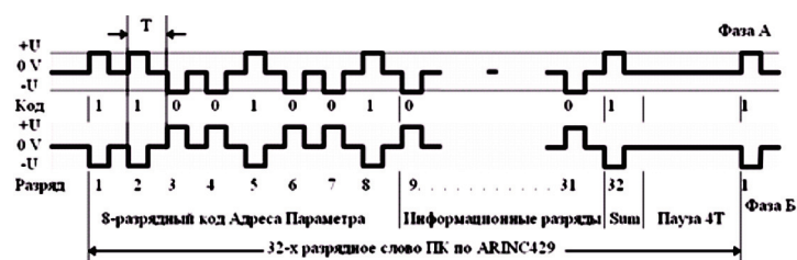
Рис. 1. Вид сигналов и структура слова последовательного кода по стандарту ARINC-429.
